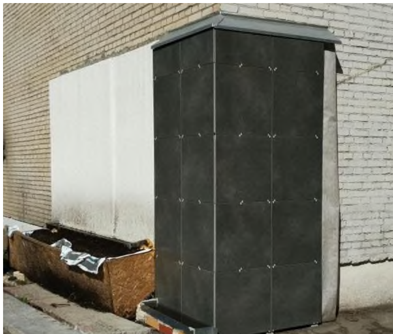
Рис. 3. Экспериментальный стенд для моделирования условий эксплуатации основных видов теплоизоляционных материалов в составе различных фасадных систем на стене акустического корпуса НИИ строительной физики РААСН
