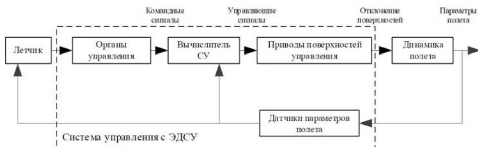
Рис. 1.1. Схема управления самолетом с использованием ЭДСУ
