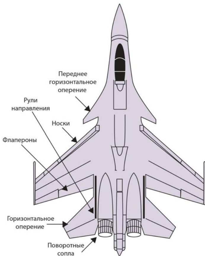
Рис. 1.5. Поверхности управления маневренного самолета
