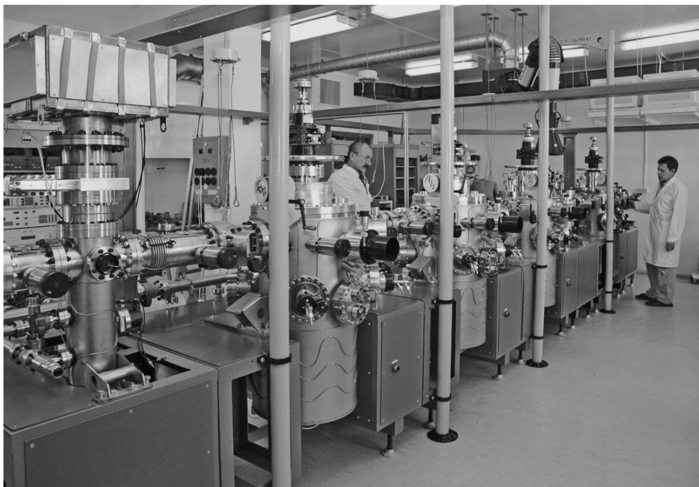
Фото 3. Комплекс установок молекулярно-лучевой эпитаксии наноструктур на основе соединений кадмий–ртуть–теллур
