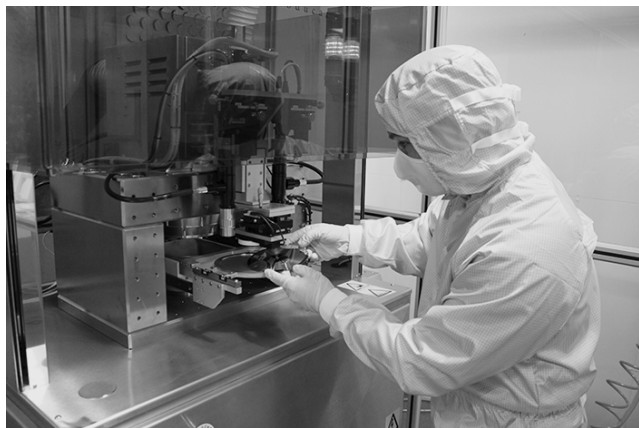
Фото 5. Установка для формирования наноструктур методом импринт-нанолитографии
