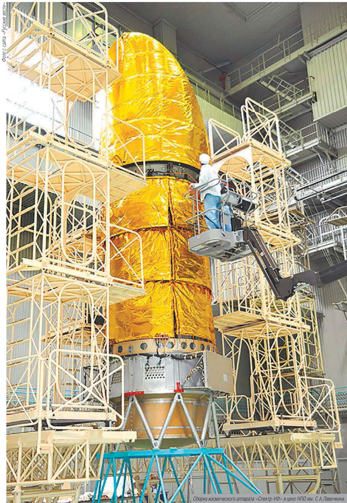
Сборка космического аппарата «Спектр-УФ» в цехе НПО им. С.А.Лавочкина.
