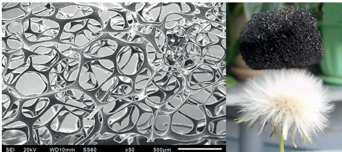
Электронно-микроскопическое изображение ячеистого углерода (слева) и его образец в натуральную величину на одуванчике (справа), \rho_{\text{нас}} = 0,02 \text{ г/см}^3
