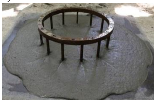
Рис. 1. Фибробетонная смесь при испытании по определению подвижности с использованием блокировочного кольца (J кольца).
