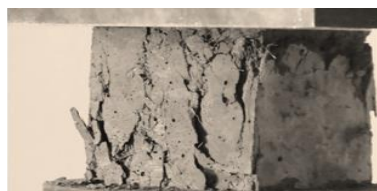
Рис. 2. Характер хрупкого (взрывного) разрушения элемента высокопрочного бетона: без фибры (а) и квазипластичного с фиброй (б).
