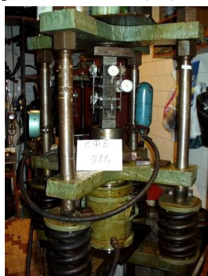
Рис. 3. Определение деформаций ползучести СВФБ при уровнях напряжений 0,8R_b
