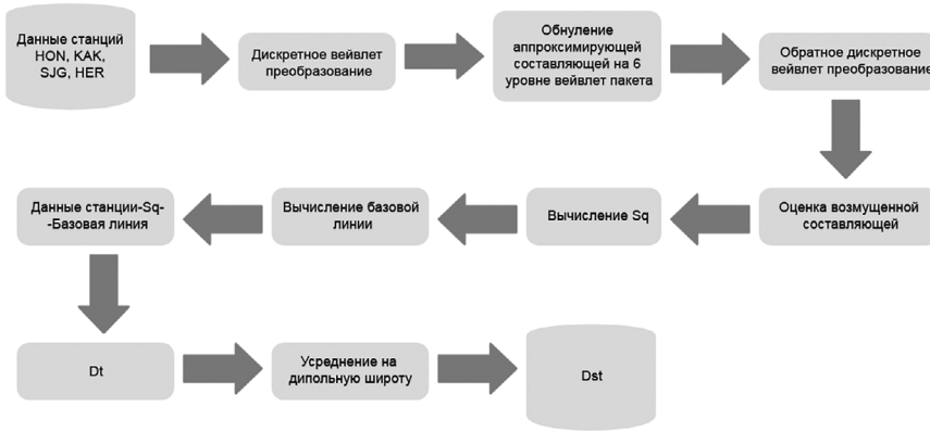
Рис. 6. Схема вычисления Dst -индекса
