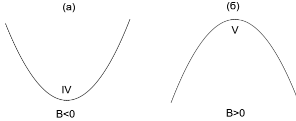
Рис. 12. Форма графика потенциала U для осциллятора (22) в случае K(0) = 0 . (а) B < 0 . (б) B > 0 .
