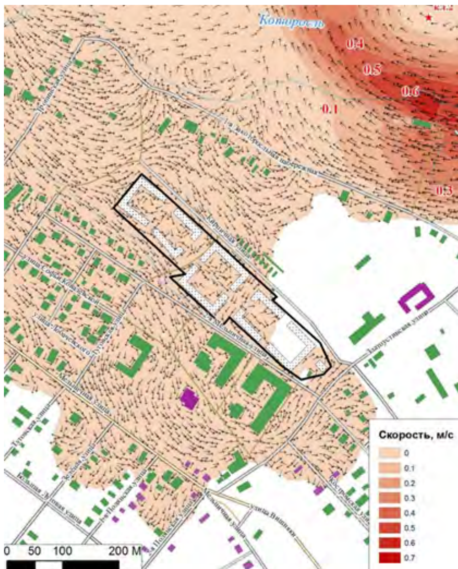
Рис. 8.3.8. Поле скоростей течения воды в устье р. Которосль (с учетом перспективной застройки) при развитии прорана в Шекснинском створе Рыбинского гидроузла через двое суток после начала аварии
