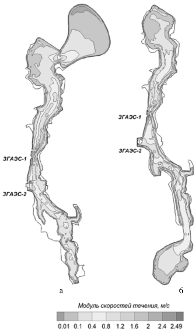
Рис. 6.4.4. Модули максимальных скоростей течения в нижнем бассейне Загорских ГАЭС: а) для расширения в низовую сторону (вариант «Сапожок»); б) для расширения в верховую сторону
