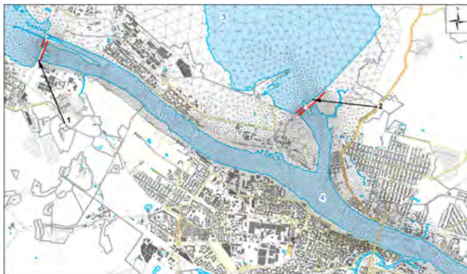
Рис. 8.3.4. Фрагмент расчетной сетки русла и поймы р. Волга в районе г. Рыбинска. 1 – Волжский створ; 2 – Шекснинский створ; 3 – Рыбинское водохранилище; 4 – Горьковское водохранилище (р. Волга)
