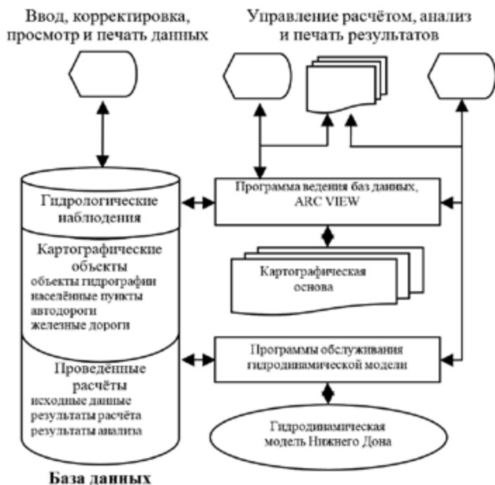
Рис 4.2.1. Структура информационно-аналитического комплекса «Нижний Дон»
