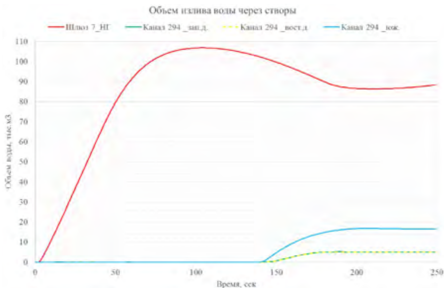
Рис. 7.2.11. Объемы излива через ворота нижней головы шлюза № 7 и через западную, восточную и южную дамбы канала № 294
