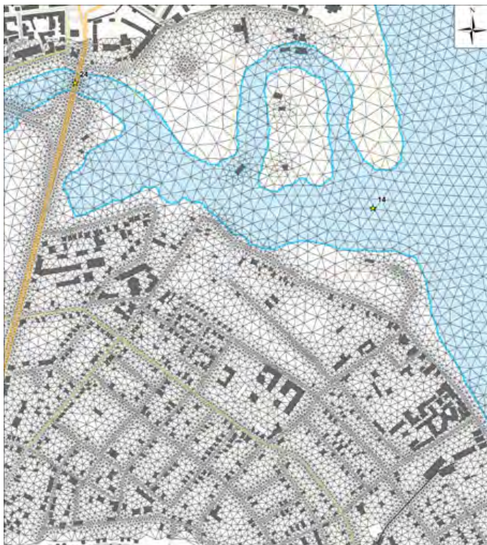
Рис. 8.3.3. Расчетная сетка на г. Ярославль с учетом зданий и сооружений. Фрагмент в районе устья р. Которосль
