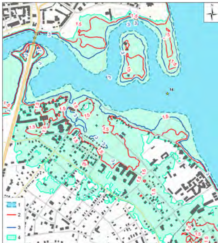
Рис. 8.3.7. Глубины затопления г. Ярославль волной прорыва. Фрагмент в районе устья р. Которосль. 1– линия НПУ = 84,0 м; 2– линии глубин 1,5 м; 3 – линия глубин 3,0 м; 4 – зона затопления
