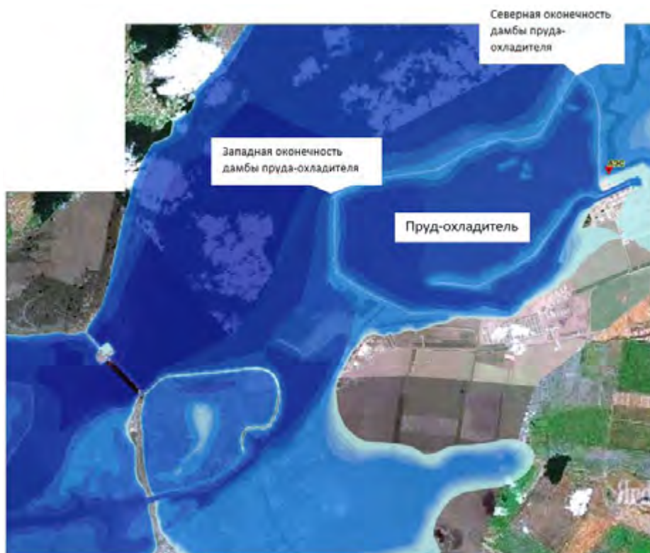
Рис. 9.1.5. Максимальные глубины затопления в районе Балаковской АЭС при прохождении волны прорыва Жигулевского гидроузла на фоне половодья с расходом 0,01% обеспеченности
