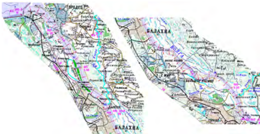
Рис. 3.3.1. Электронная топографическая карта бассейна р. Волга на участке Городец-Сормово с нанесенными поперечниками
