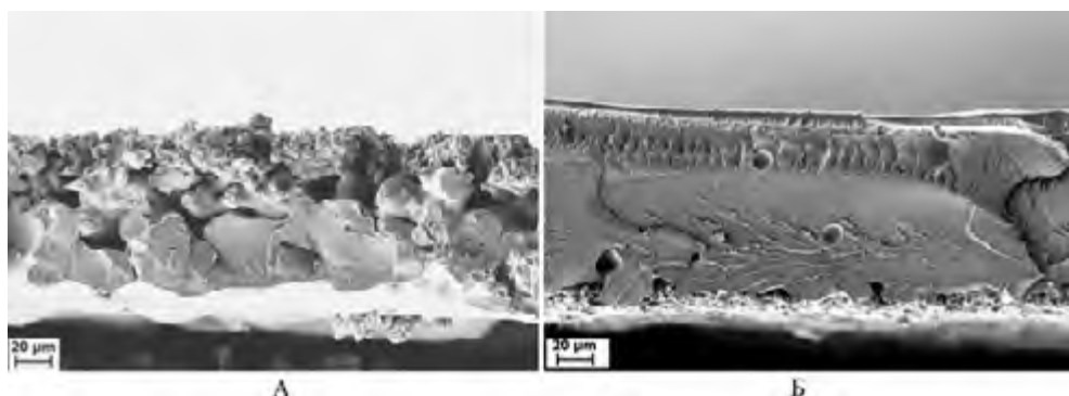
Рис. 70. СЭМ скола полиимидных пленок, полученных методом СЛС на основе: А -ТИ порошка Р-ОДФО; Б - ХИ порошка Р-ОДФО
