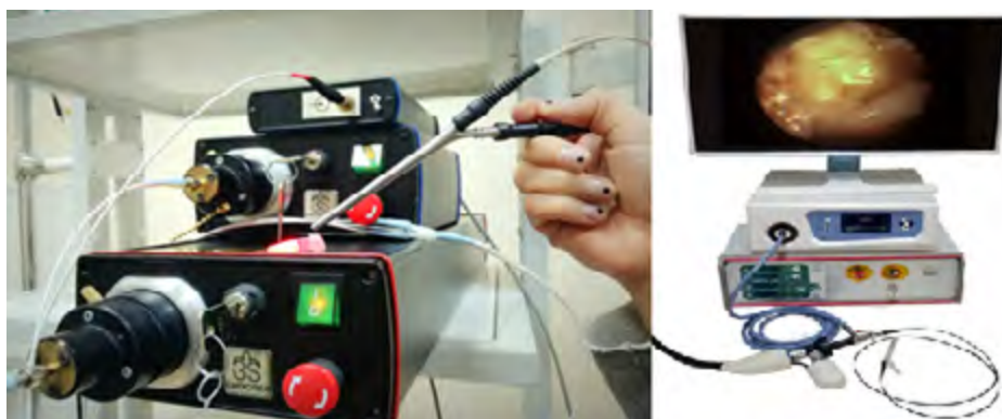
Рис. 8. Установка для комбинированного анализа спектров флуоресценции опухолевого маркера и спектров поглощения гемоглобина (а); видеосистема для флуоресцентной навигации
