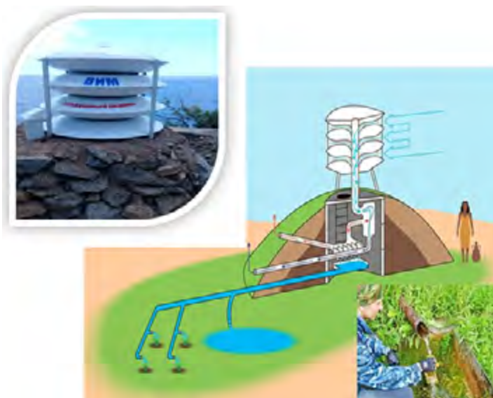
Рис. 10. Установка и технологическая схема получения воды из атмосферного воздушного потока
