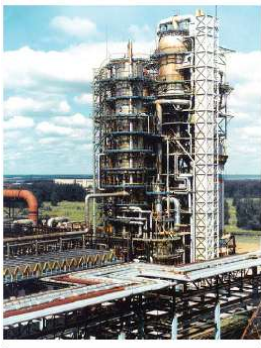
Современная установка каталитического крекинга «вакуумных дистиллятов» мощностью 1 млн т в год по сырью, работающая на Омском НПЗ
