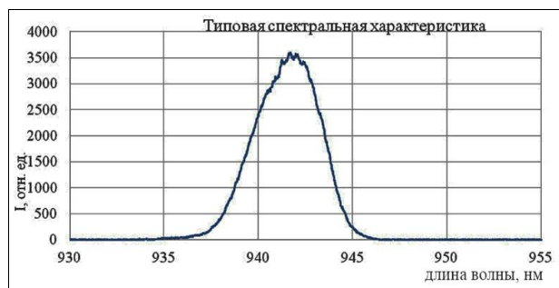
Рис.2 Спектр излучения лазера ЛПИ-940-7500, измеренный с помощью спектрометра МС-300.
