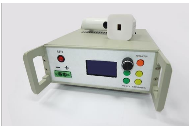
Рис.1 Внешний вид полупроводникового импульсного лазера ЛПИ-940-7500
