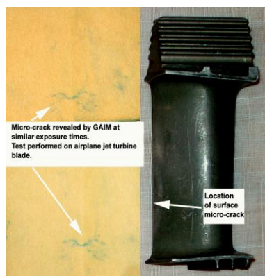
Рис. 6. Портреты трещин на кромке лопатки авиационного двигателя, полученные через разные промежутки времени (ГАИМ)
